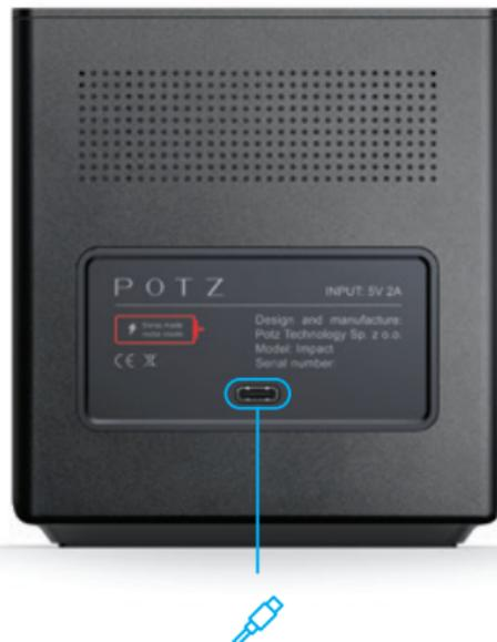
Der USB-C-Anschluss zum Aufladen des Geräts befindet sich auf der Rückseite des Geräts.
